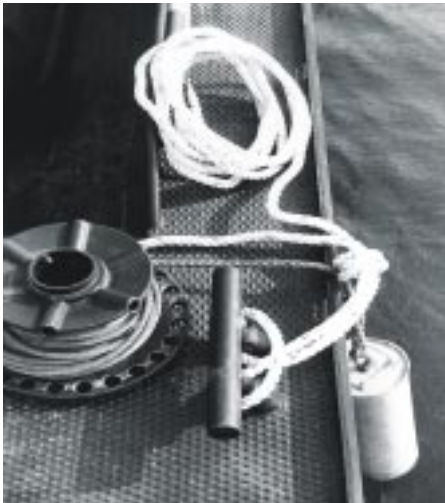
Vorbereitete Halteleine fest an der hinteren Belegklampe
