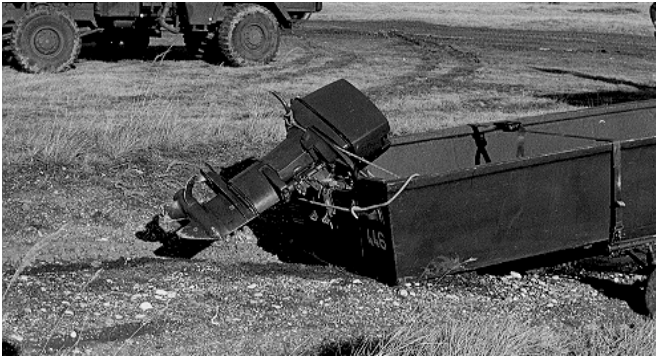
Motor mit Bindeleine gesichert
