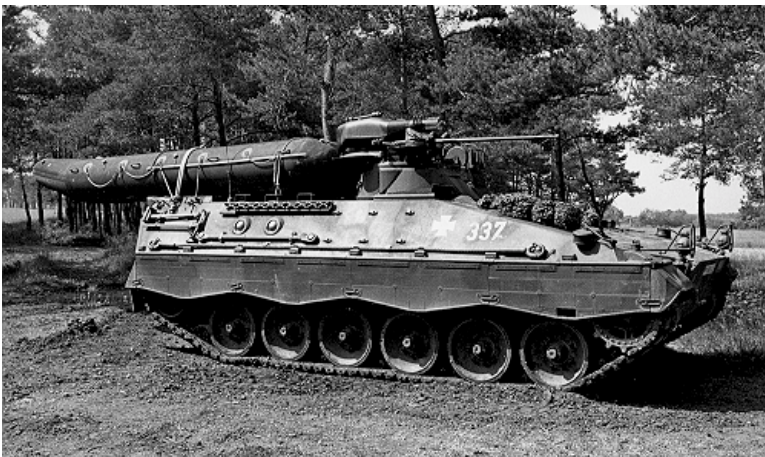
Großes Schlauchboot auf SPz Marder – Längsverlastung
