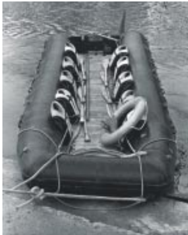
Großes Schlauchboot als Rettungsboot ausgerüstet.
