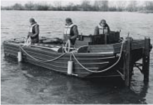
Motorboot, fertig zum Aufnehmen eines schwimmfähigen Landfahrzeugs an Steuerbord
