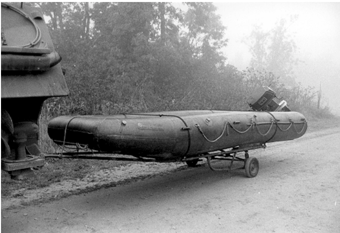
Schlauchboot auf Transportachse verlastet, angehängt an TPz Fuchs
