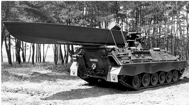
SPz Marder mit verlastetem Sturmboot auf Lastrahmen
