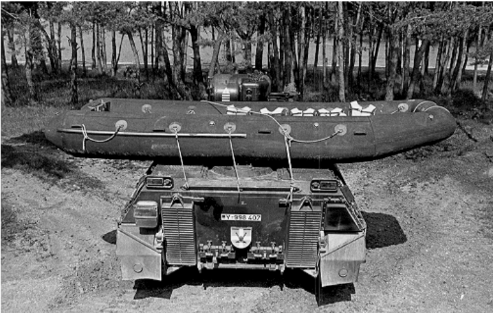
Großes Schlauchboot auf SPz Marder – Querverlastung
