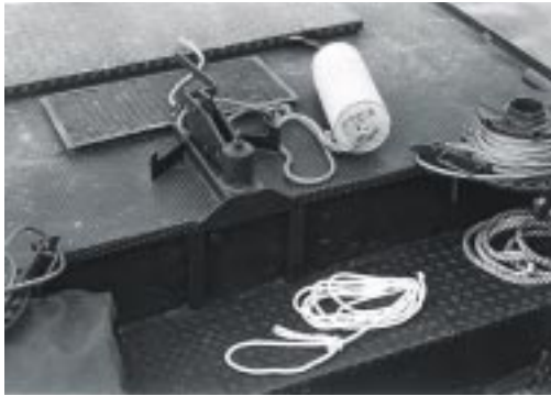
Bereitliegender Fender und bereitliegende Bindeleine (Beispiel: Motorboot, klein)
